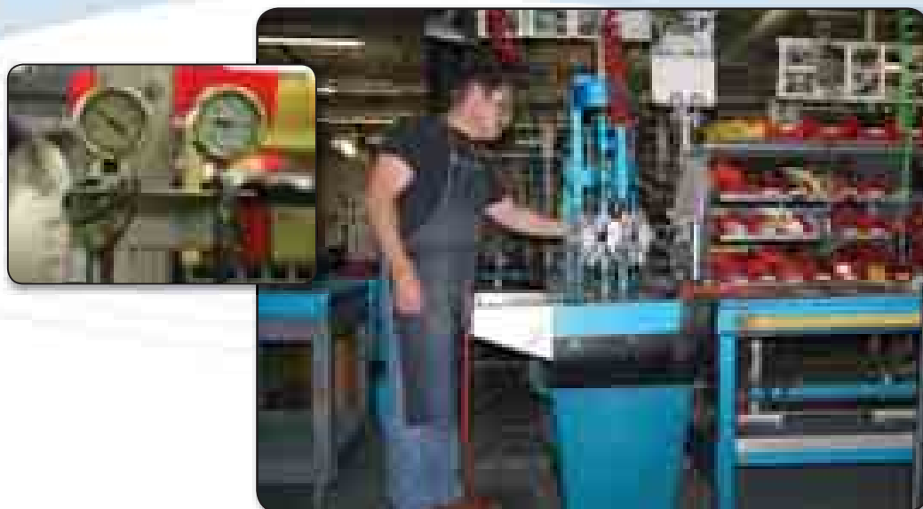
Опытный сборщик Warren Rupp следит за работой насоса по манометрам и вакуумметрам.
