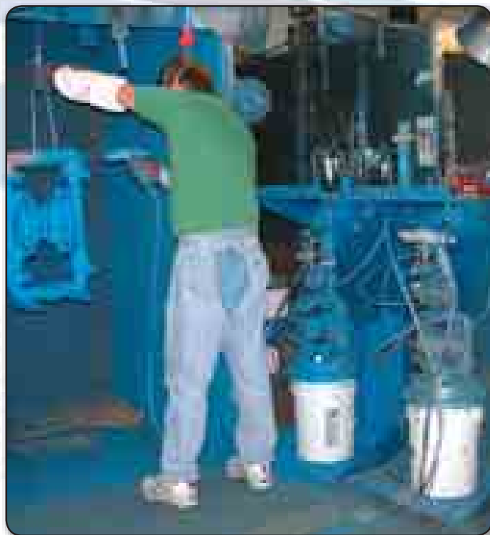
Окрасочная кабина. Насосы SANDPIPER®, установленные на ведрах.
